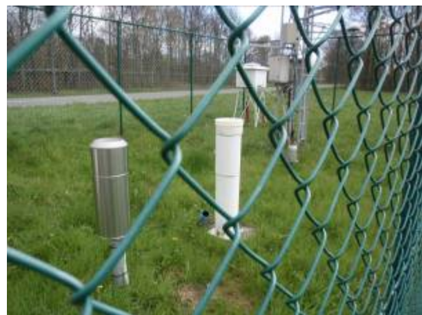
Photos 2a et 2b : Photographies prises au parc météo du domaine universitaire du Sart Tilman (ST -ULg) au sud de la ville de Liège, Belgique. Photo de gauche : Disdromètre à laser chauffé (Thies) et toute une série d'autres instruments pour le suivi des hydrométéores. Photo de droite : Pluviographe à pesée (OTT) sans coupe-vent au premier plan et pluviographe (Précis-Mécanique) à auget basculeur (0,2 mm de résolution) au deuxième plan.
