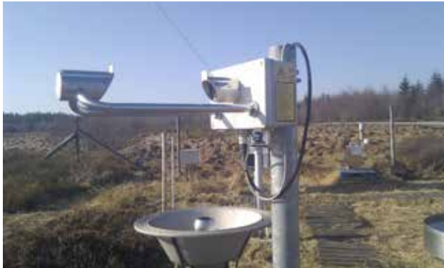
Photos 1a et 1b : Photographies prises au parc météo de la Station Scientifique des Hautes Fagnes (SSHF-ULg) au Mont Rigi (MR), Belgique. Photo de gauche : Disdromètre à laser chauffé (Thies). Au centre de la photo de droite : Pluviographe à pesée (OTT) avec coupe-vent.
