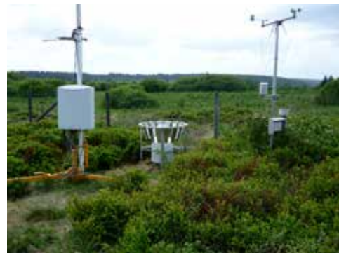
Photos 1a et 1b : Photographies prises au parc météo de la Station Scientifique des Hautes Fagnes (SSHF-ULg) au Mont Rigi (MR), Belgique. Photo de gauche : Disdromètre à laser chauffé (Thies). Au centre de la photo de droite : Pluviographe à pesée (OTT) avec coupe-vent.
