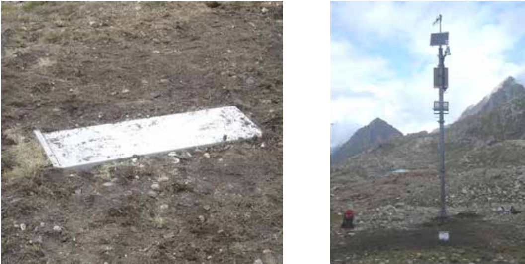
Figure 4 : Le capteur RC (à gauche) et (à droite) une vue complète du NRC de Spijeoles dans les Pyrénées.
