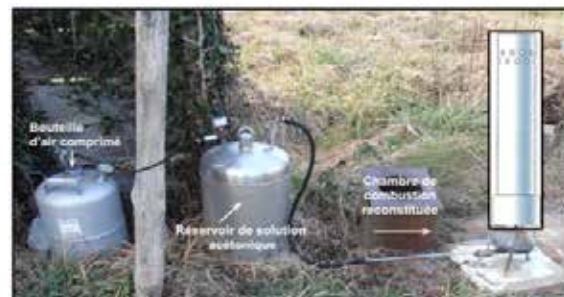
Figure 7 : Exemple de générateur de noyaux glaçogènes type Vortex (la chambre de combustion démontée a été reconstituée schématiquement sur la photo).
