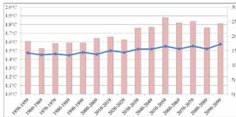
Figure 4 : Courbe représentant l'intensité moyenne de l'ICU (courbe, en °C) et le nombre de jour moyen par an où l'ICU est supérieur ou égal à 3°C (bâtons).
