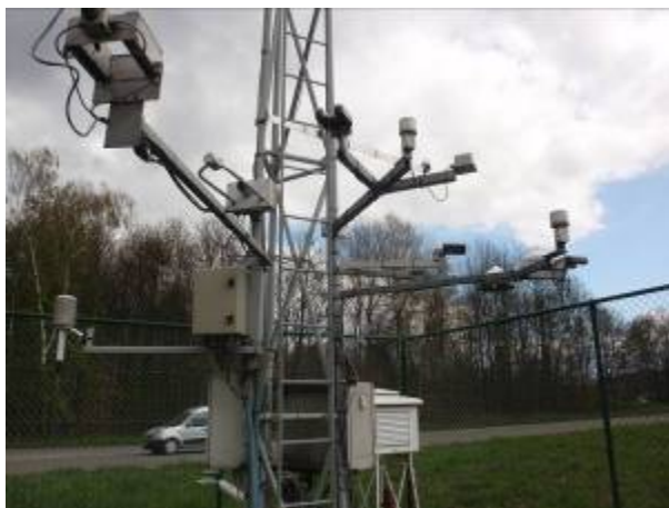
Photos 2a et 2b : Photographies prises au parc météo du domaine universitaire du Sart Tilman (ST -ULg) au sud de la ville de Liège, Belgique. Photo de gauche : Disdromètre à laser chauffé (Thies) et toute une série d'autres instruments pour le suivi des hydrométéores. Photo de droite : Pluviographe à pesée (OTT) sans coupe-vent au premier plan et pluviographe (Précis-Mécanique) à auget basculeur (0,2 mm de résolution) au deuxième plan.
